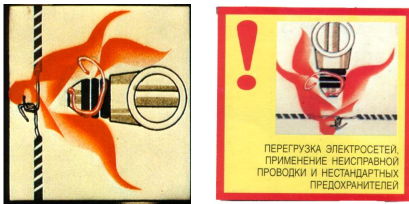
Неисправный предохранитель с «жучком»
